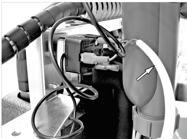
Abb. 73: mSTB mit Anschlussleitung
