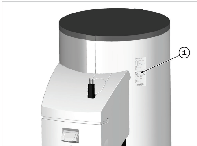
Abb.112: Typenschildkopie (1) auf Isolierung geklebt
