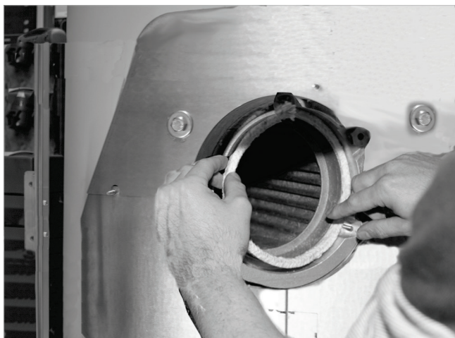
Abb. 29: Brennerdichtschnur einlegen, Stoß oben
