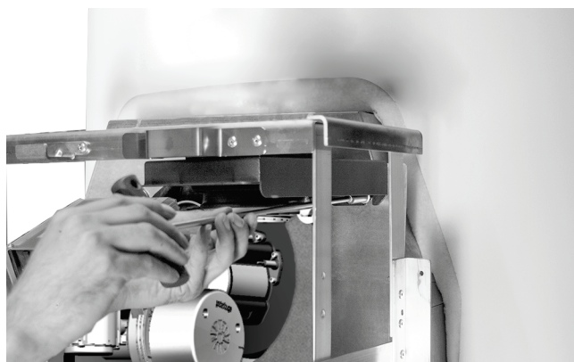
Abb. 37: Halter Balgdichtung festschrauben
