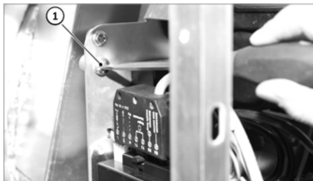
Abb. 117: Schnellverschlusschrauben an Brennereinsatz
