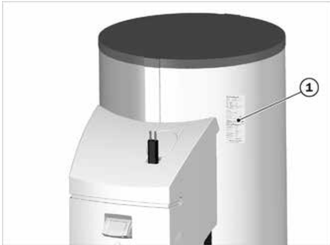
Abb.112: Typenschildkopie (1) auf Isolierung geklebt
