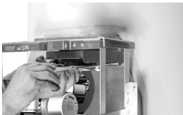
Abb. 37: Halter Balgdichtung festschrauben
