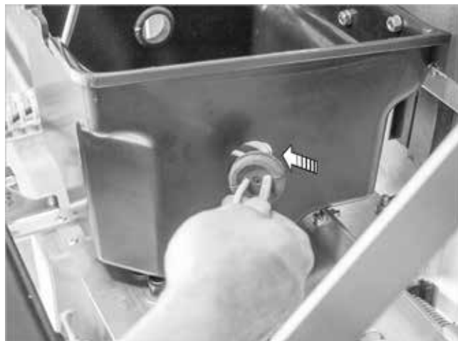
Abb. 35: Brennerkabel luftdicht durchleiten
