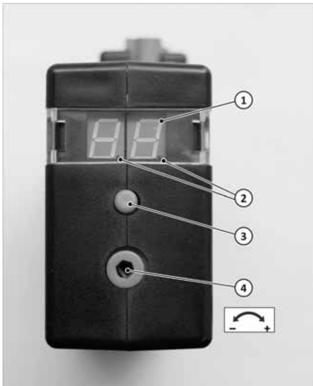
Abb. 103: Gebläsedrehzahl am Interface einstellen
