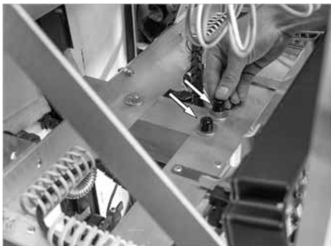
Abb. 33: Schraubenköpfe an Konsole abdecken
