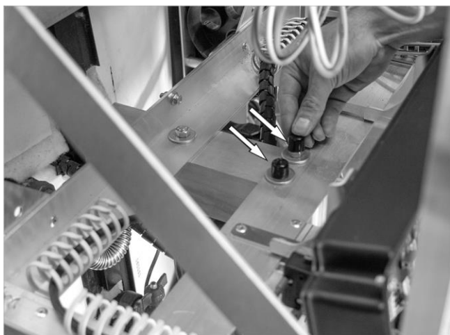
Afb. 10: Boutkoppen op console bedekken
