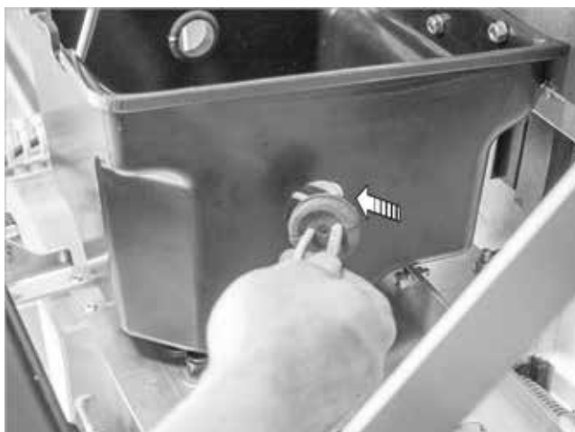
Afb. 12: Branderkabel luchtdicht doorvoeren
