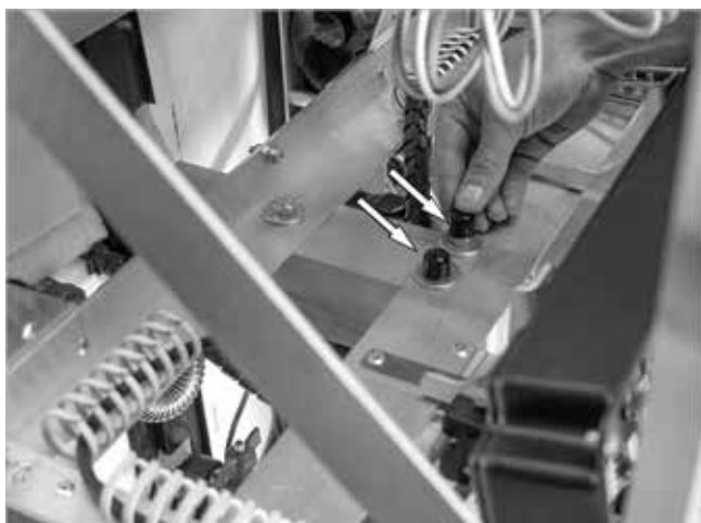
Afb. 10: Boutkopen op console bedekken
