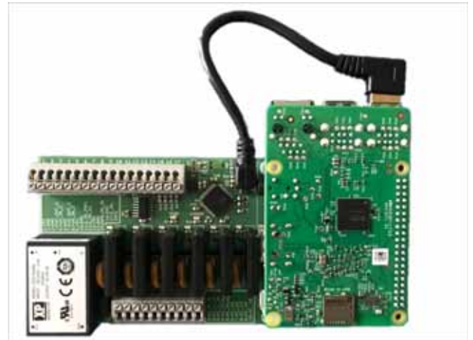
Abb. 9: Relaisplatine V 4.2 mit Steuerungs-PC
