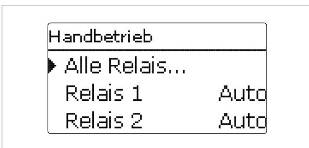
Abb. 25: Relais auf Automatik-Betrieb schalten
