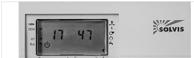
Abb. 14: Rechts im Display den Wert „47“ einstellen
