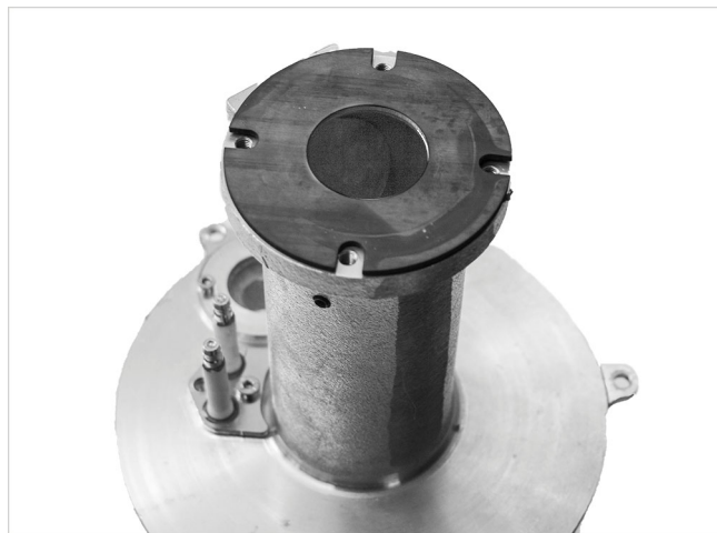
Abb. 6: Gebläseflanschdichtung korrekt auflegen
