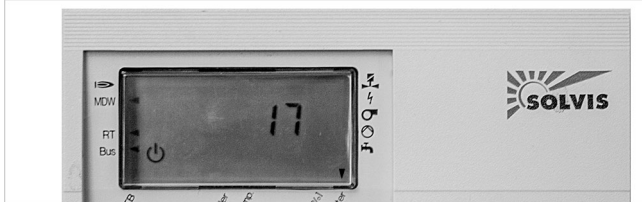
Abb. 13: Rechts im Display „17“ einstellen
