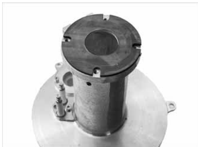
Abb. 6: Gebläseflanschdichtung korrekt auflegen
