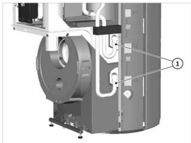
Abb. 31: Anschlüsse HKS kontrollieren / nachziehen
