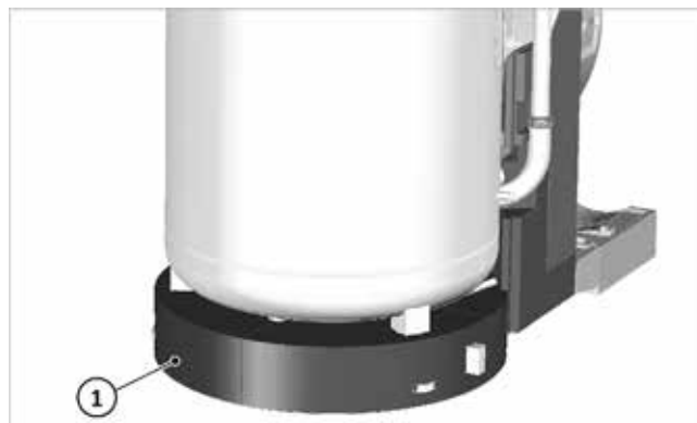
Abb. 13: Bodenrunde unter den Speicher legen
