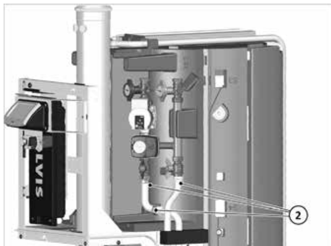
Abb. 32: Anschlüsse VL- / RL-Winkel kontrollieren / nachziehen
