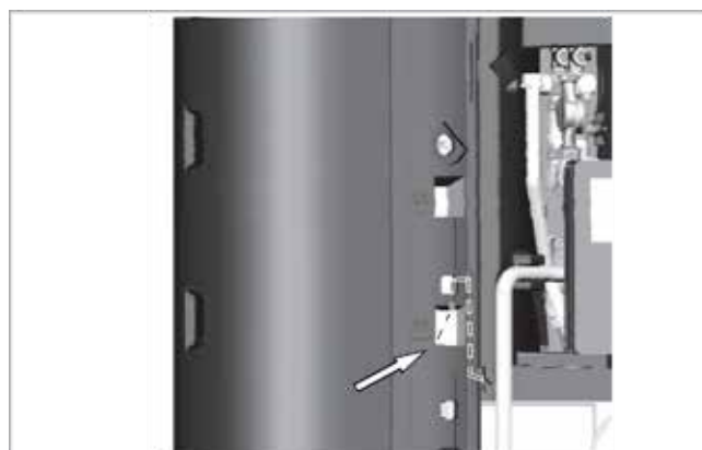
Abb. 24: Sensor S1 in Position S1-Komfort montieren
