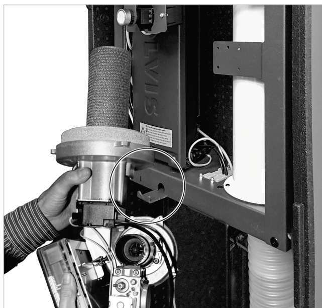
Abb. 141: Brenner an Konsole einhängen (Wartungsposition)
