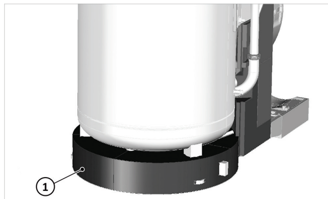
Abb. 13: Bodenrunde unter den Speicher legen
