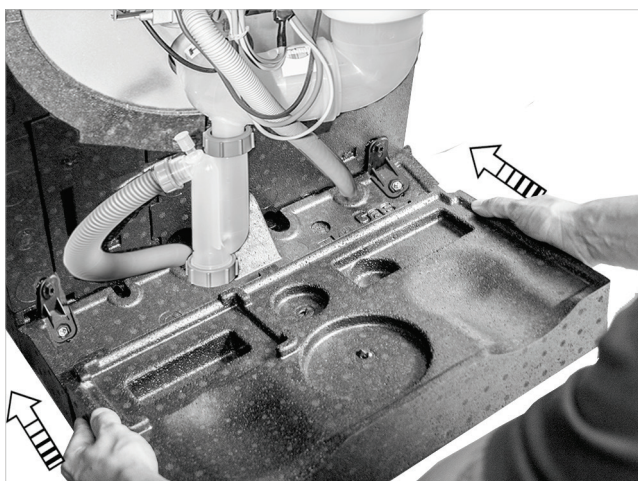
Abb. 97: Vorderes Bodenteil einstecken
