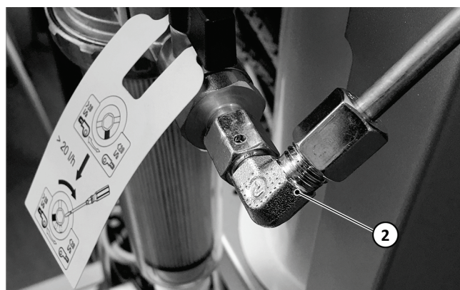
Abb. 82: Ölzuleitung am Filter anschließen
