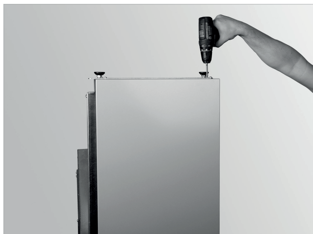
Abb. 51: Jeweils 1 Kreuzschraube entfernen
