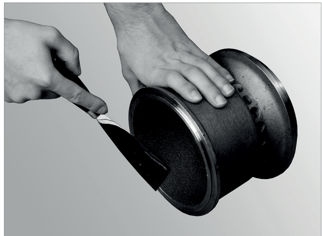
Abb. 147: Konus mit Spachtel reinigen
