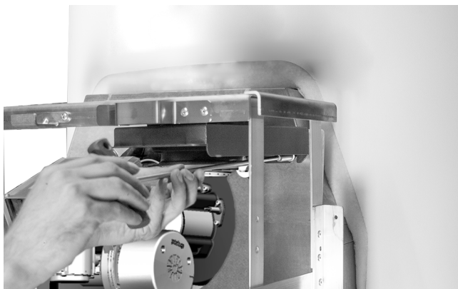
Abb. 38: Halter Balgdichtung festschrauben
