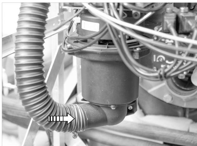
Abb. 59: Zuluftschlauch am Gebläse befestigen
