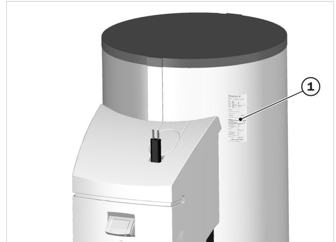
Abb.112: Typenschildkopie (1) auf Isolierung geklebt
