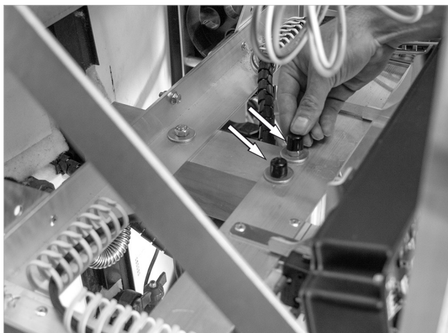
Abb. 34: Schraubenköpfe an Konsole abdecken
