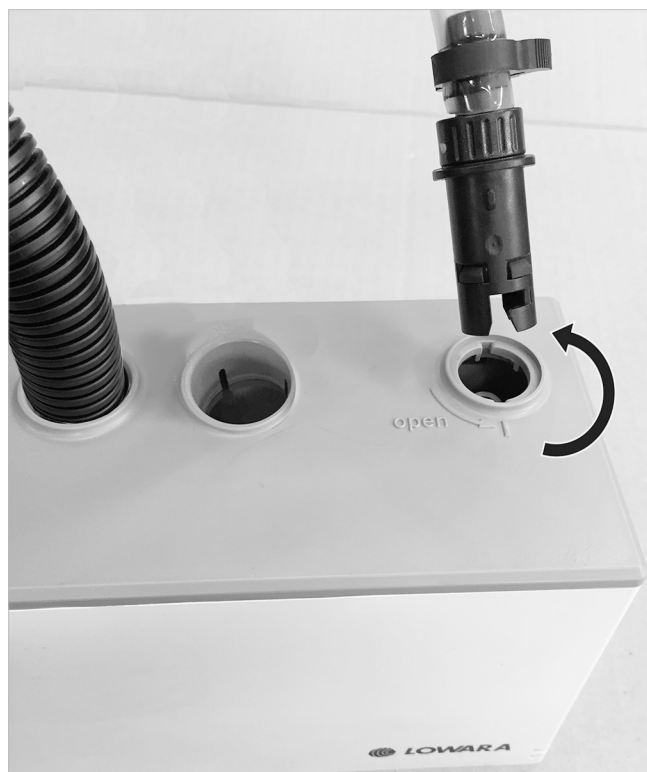
Abb. 33: Druckschlauch mit ¼-Umdrehung demontieren
