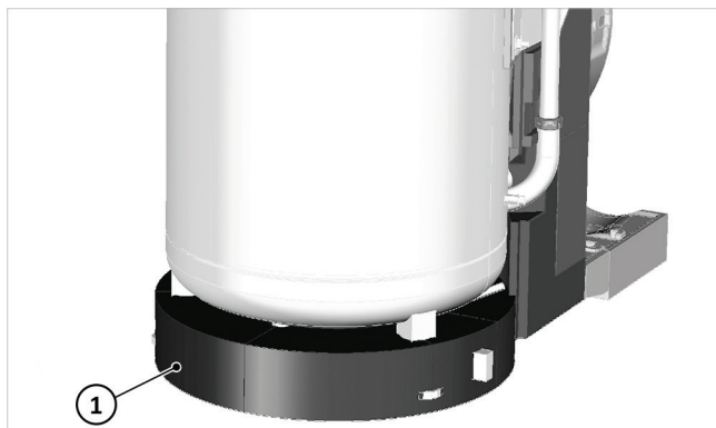
Afb. 13: Rond vloerdeel onder de boiler leggen
