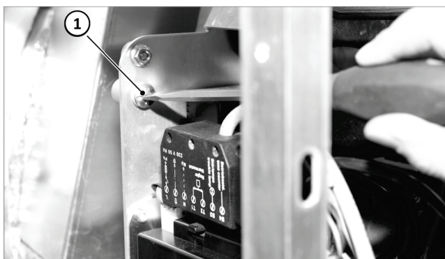
Afb. 144: Snelsluitbouten op het branderinzetstuk
