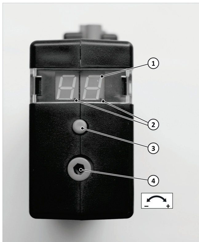
Afb. 117: Ventilatoroerental op interface instellen
