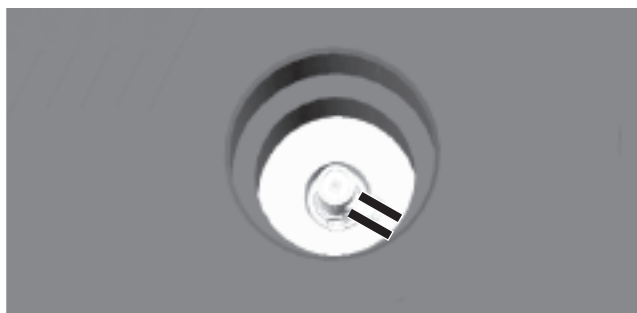
Afb. 140: Ontluchtingsslang bij ontluchter
