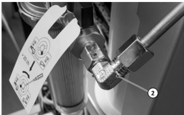
Afb. 82: Olietoevoerleiding op filter aansluiten
