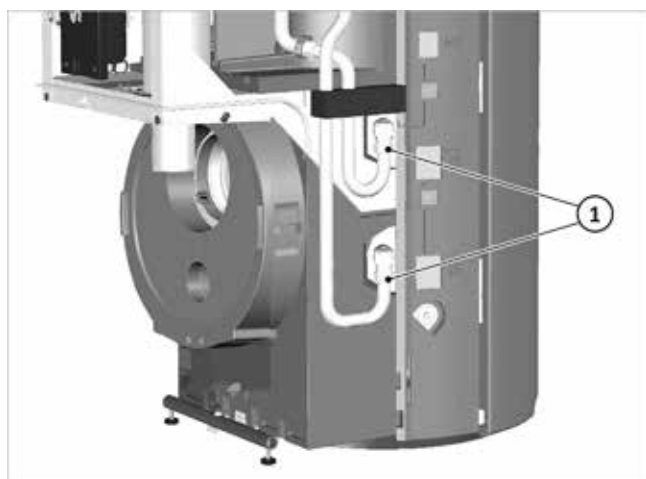
Afb. 31: De aansluitingen van de HKS controleren/vastdraaien
