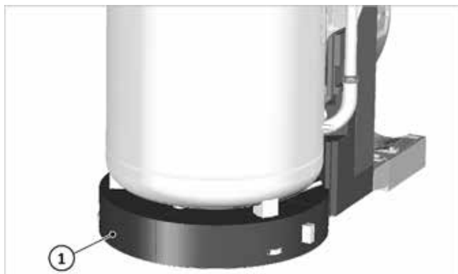
Afb. 13: Rond vloerdeel onder de boiler leggen
