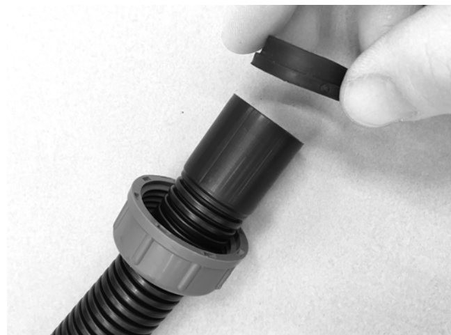
Afb. 4: Wartelmoer en pakkingring aanbrengen
