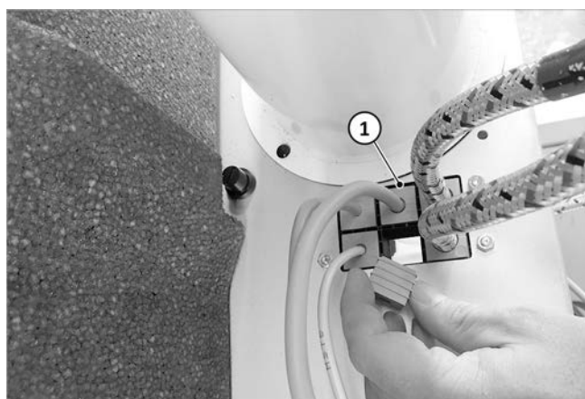
Afb. 10: Blinde stop verwijderen
