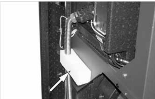
Abb. 11: Schaumstoffkeil anbringen, Verkleidung schließen
