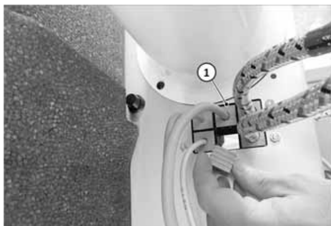
Fig. 10 : retirer l'obturateur dans la tôle de fond
