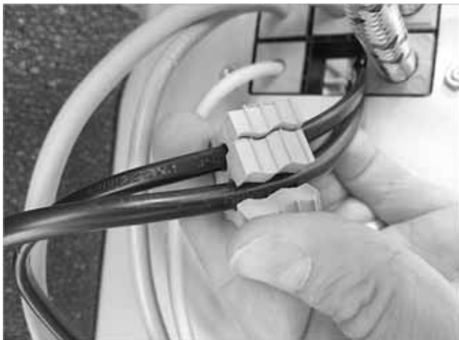
Fig. 13 : placer le passe-câble autour du câble
