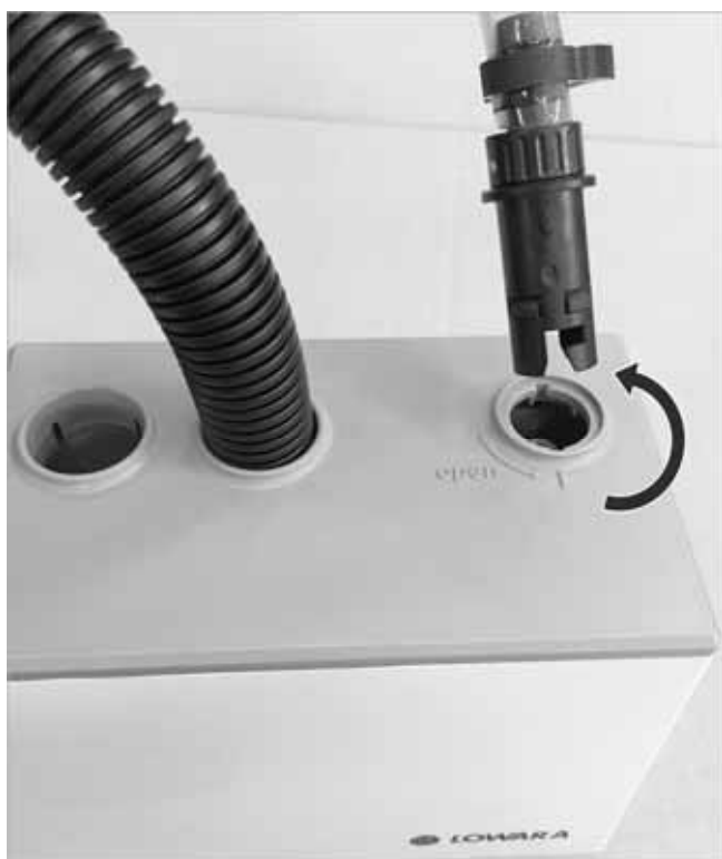
Fig. 7 : monter le tuyau de refoulement avec \frac{1}{4} de tour dans le sens des aiguilles d'une montre
