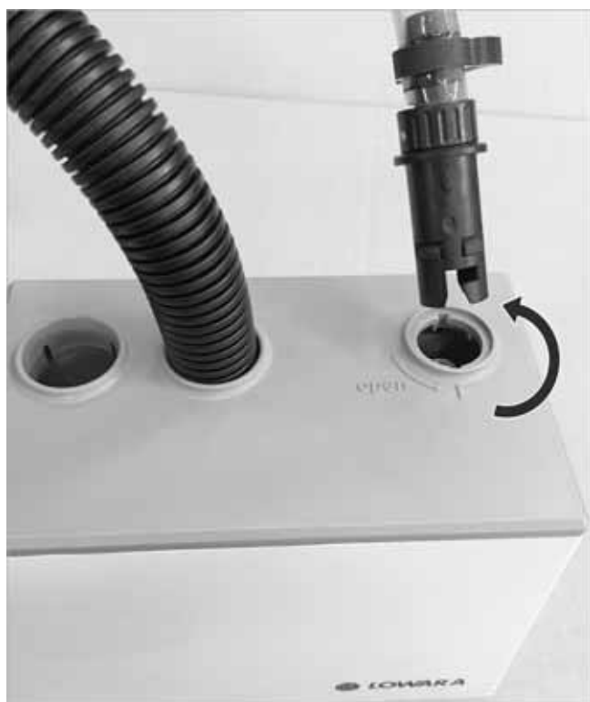
Fig. 23 : monter le tuyau de refoulement avec \frac{1}{4} de tour dans le sens des aiguilles d'une montre
