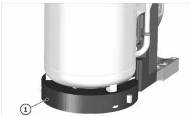
Fig. 13 : installation du socle sous l'accumulateur
