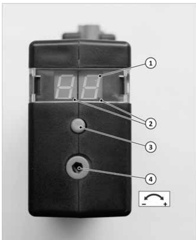
Fig. 117 : réglage du régime de la soufflante sur l'interface
