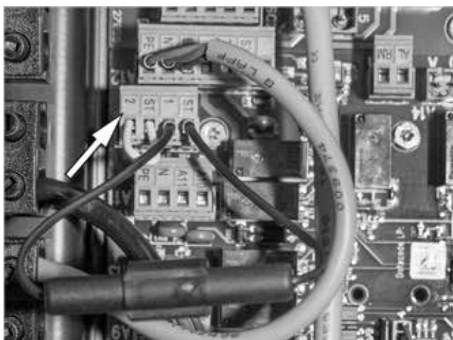
Fig. 57 : enficher la barrette de raccordement
