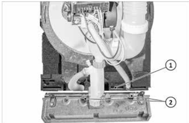
Fig. 94 : passage des câbles par le fond
