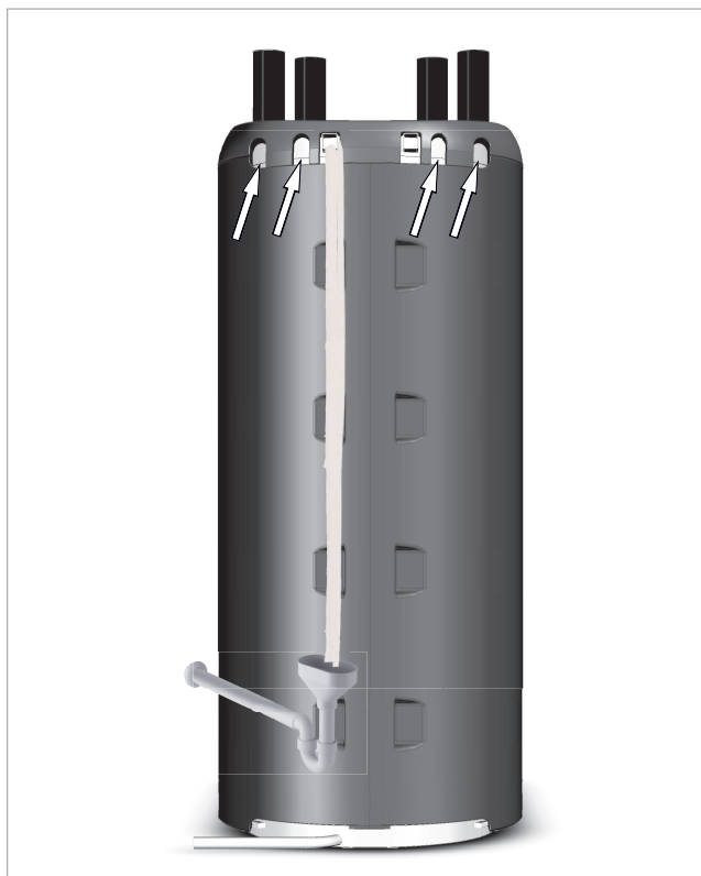
Fig. 131 : bouchons en fibres, partie arrière
