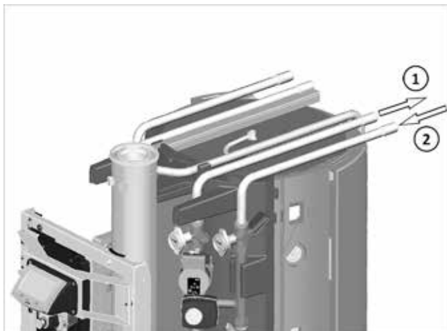
Fig. 34 : raccordement AC / RC par l'arrière
