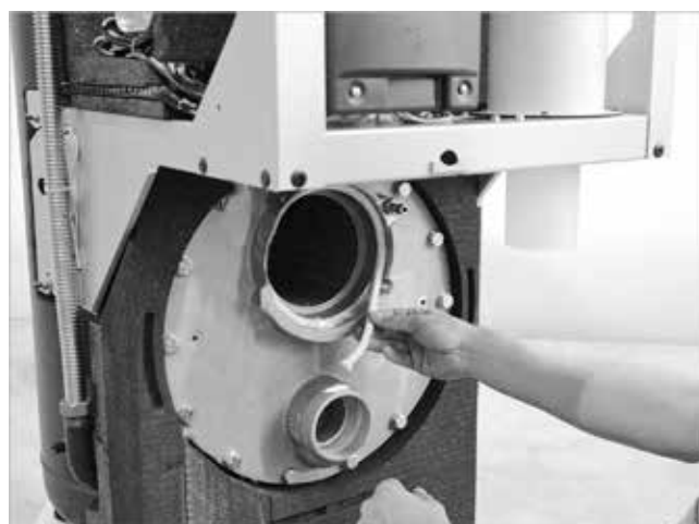
Fig. 46 : installation du cordon d'étanchéité du brûleur
