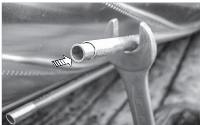
Abb. 7: Stützhülsen einsetzen (hier 8-mm-Rohr)
