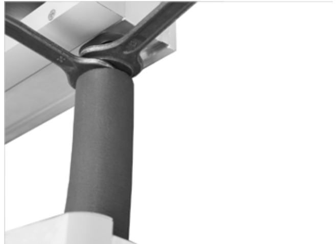
Fig. 69: VB-F-S-D-UE avvitato al raccordo superiore
