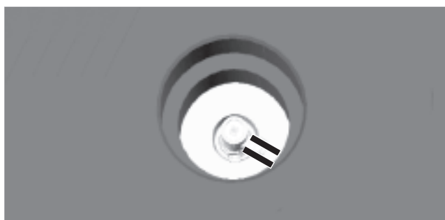
Fig. 140: tubo flessibile di sfiato dello sfiatoio
