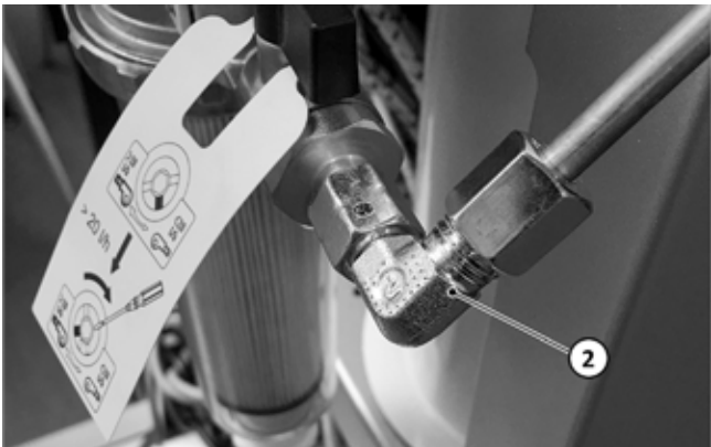
Fig. 82: Fissaggio della tubazione di alimentazione del gasolio al filtro
