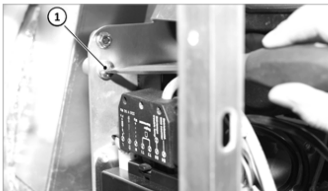
Fig. 144: Viti a serraggio rapido nell'inserto del bruciatore
