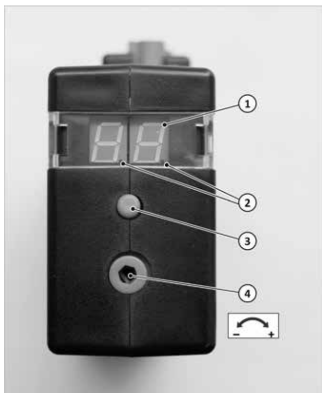
Fig. 152: Interfaccia dispositivo automatico di controllo bruciatore CM 168
