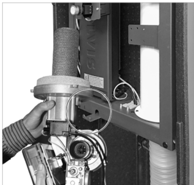
Fig. 141: Aggancio del bruciatore alla console (posizione di manutenzione)
