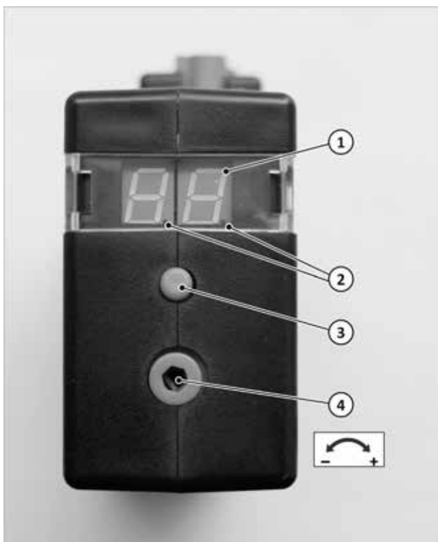
Fig. 117: Impostazione del numero di giri del soffiante dall'interfaccia
