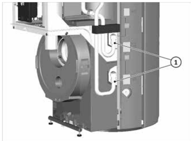
Fig. 31: Controllare/serrare gli attacchi della SCR
