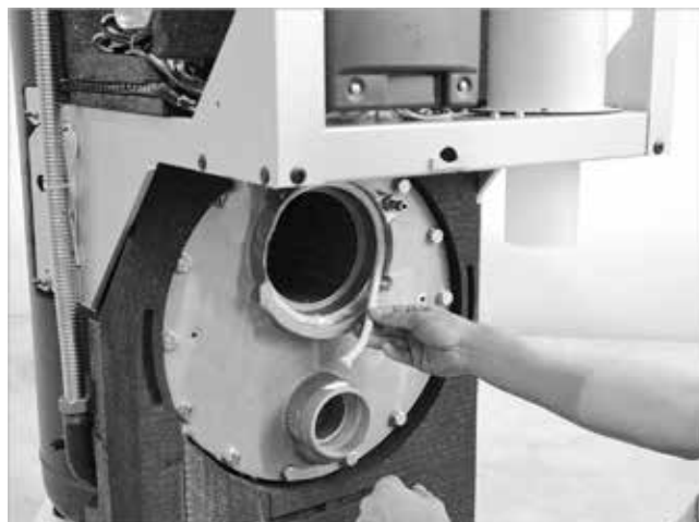
Fig. 46: Inserire il cordoncino di tenuta del bruciatore
