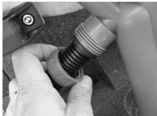
Fig. 5: Fissare il tubo flessibile condensa (SolvisBen)
