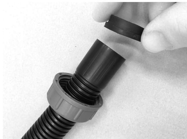
Fig. 4: Posizionare la linguetta di sicurezza e l'anello di tenuta
