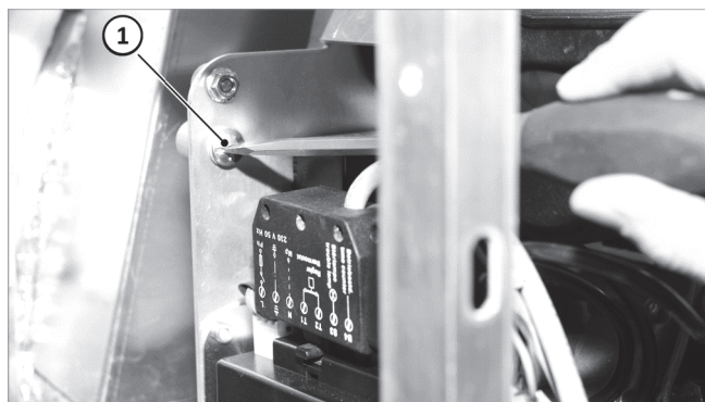
Afb. 31: Snelsluitbouten op het branderinzetstuk
