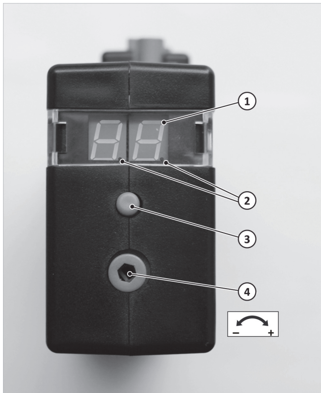
Afb. 28: Ventilatoroerental op interface instellen
