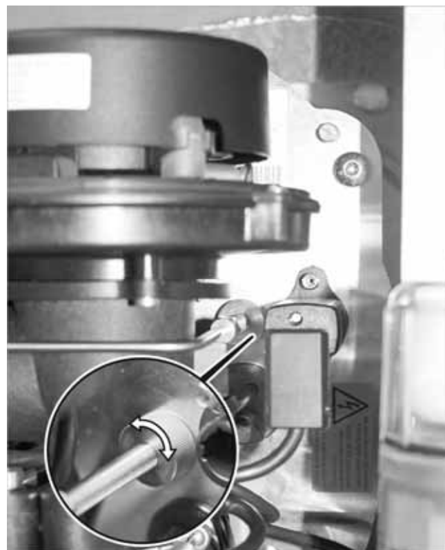
Afb. 38: Kartelmoer (aansluiting olieleiding/sproeierblok)
