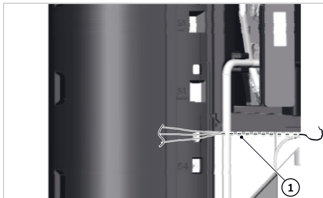
Fig. 20: Sujeción del cable espiral
