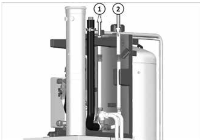
Fig. 39: Conexión de H-VL/H-RL desde arriba
