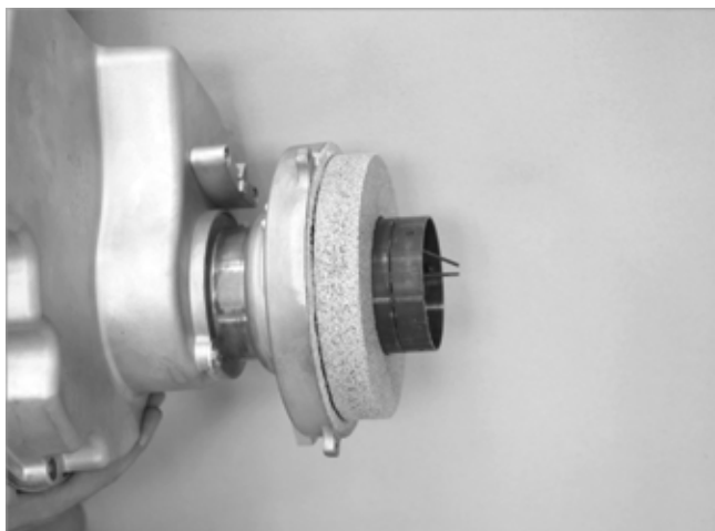
Fig. 68: Colocar el ladrillo de la puerta de la caldera
