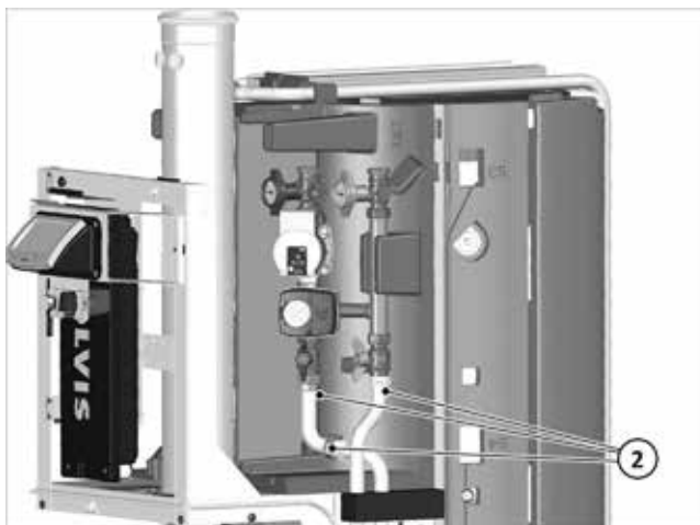
Fig. 32: Control/reapriete de las conexiones de las escuadras de avance/retorno
