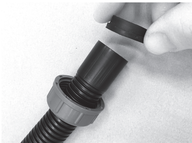
Fig. 16: Colocación del saliente y la junta anular
