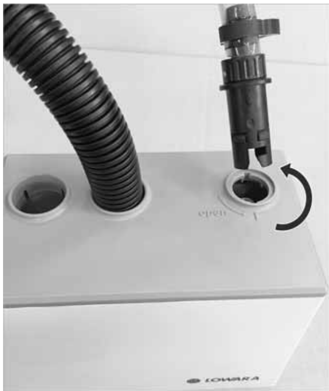
Fig. 7: Montaje del tubo flexible de presión con un \frac{1}{4} de giro
