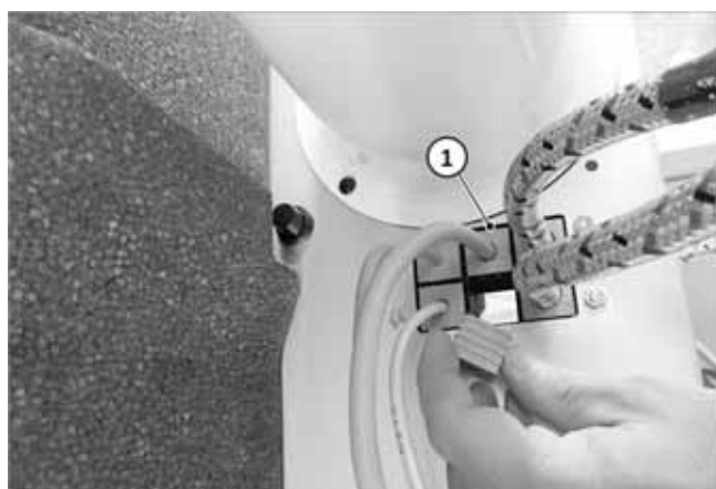
Fig. 10: Retirada del tapón ciego
