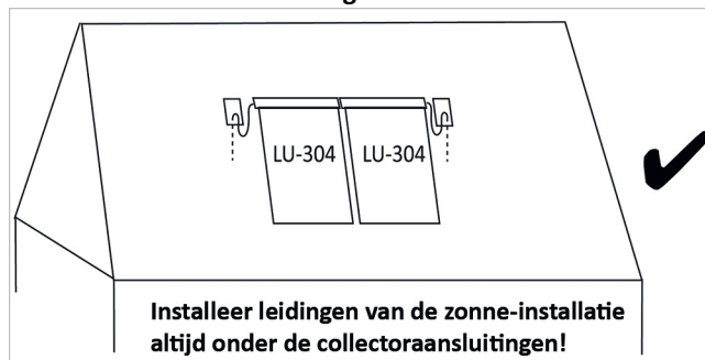
Afb. 5: Leidingen van de zonne-installatie correct uitgevoerd
