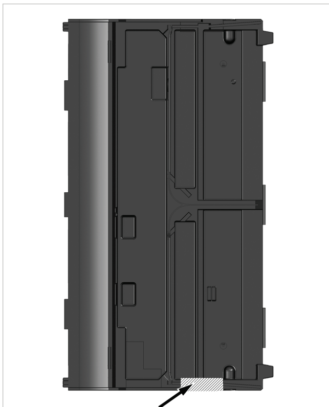
Fig. 42: taglio della parte laterale EPP interessata
