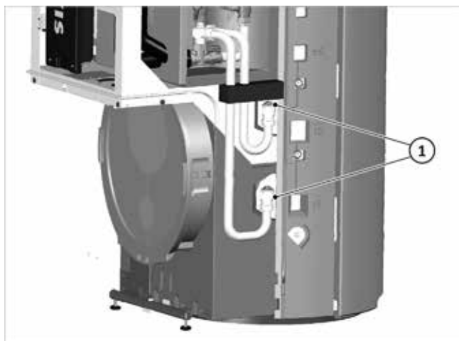
Fig. 30: controllare/serrare gli attacchi della SCR
