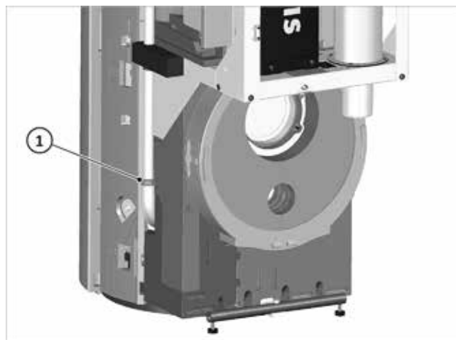
Fig. 25: controllare/serrare il raccordo a vite del ritorno
