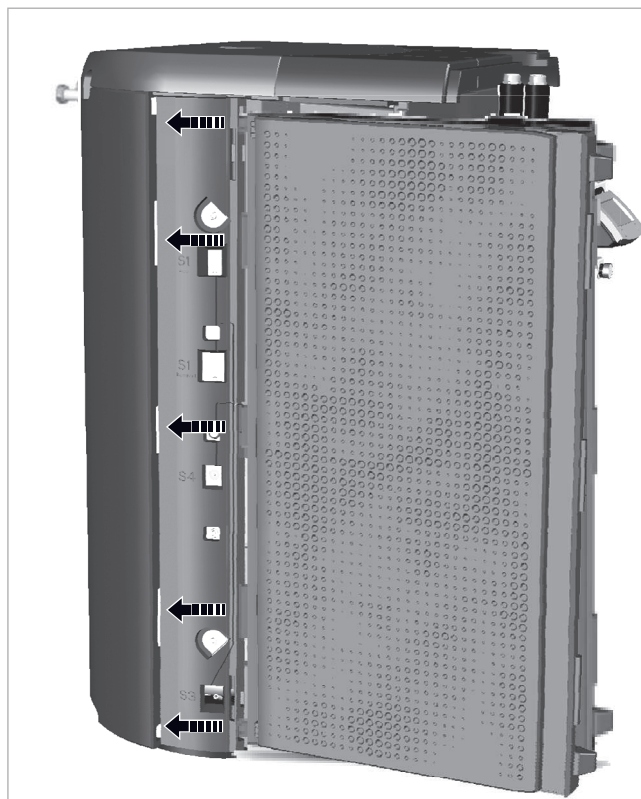
Fig. 75: Inserción de la pieza lateral
