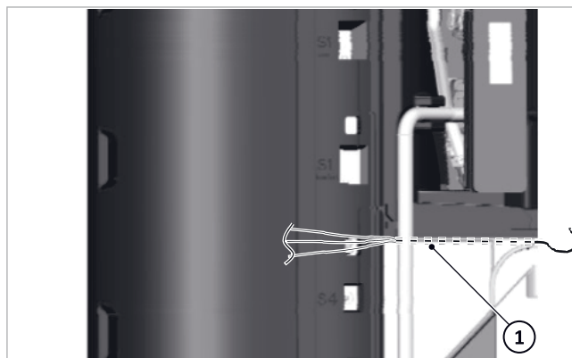
Fig. 19: Sujeción del cable espiral
