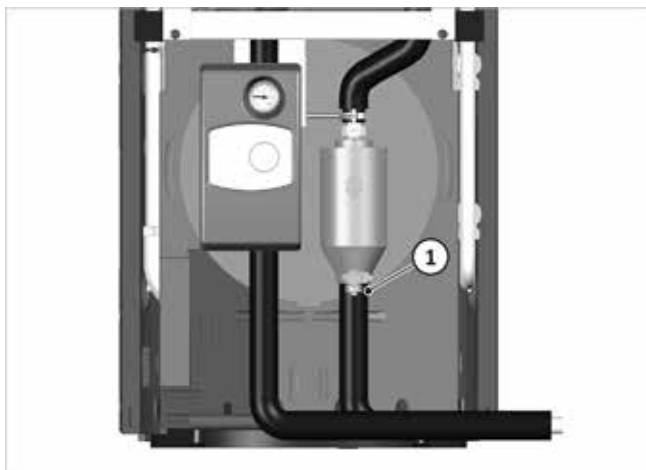
Fig. 82: Limpiar el separador de lodo mediante el grifo de vaciado
