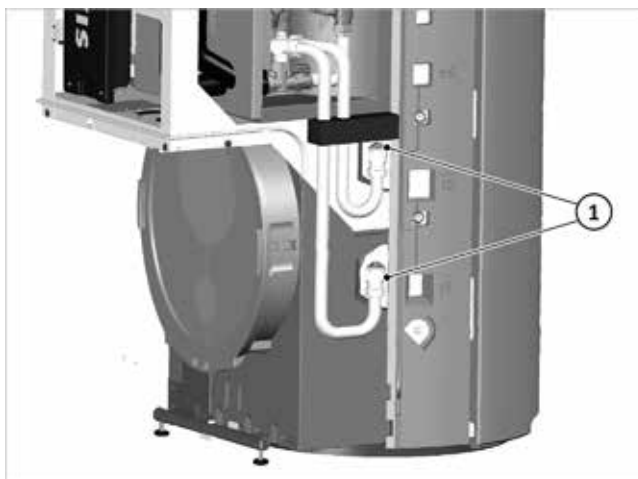
Fig. 30: Control/reapriete de las conexiones de la estación de circuito de calefacción
