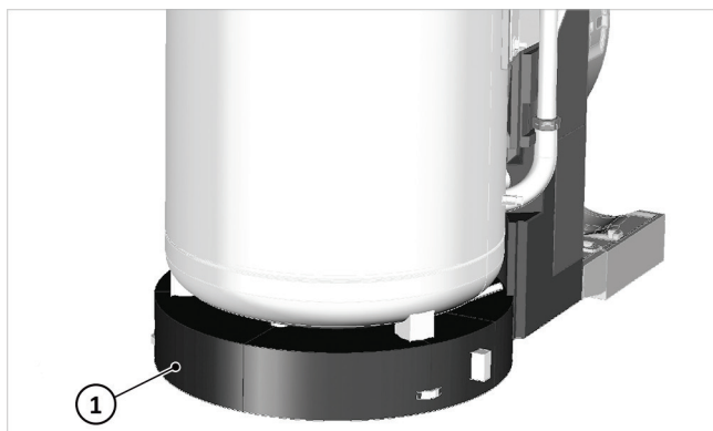
Fig. 12 : installation du socle sous l'accumulateur
