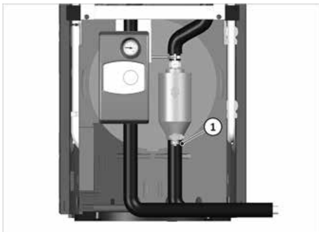
Fig. 80 : nettoyage du séparateur de boues au moyen du robinet de purge
