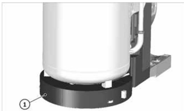
Fig. 12 : installation du socle sous l'accumulateur
