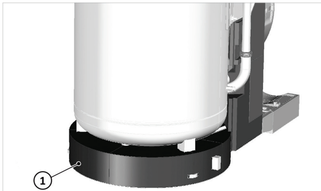
Afb. 12: Rond vloerdeel onder de boiler leggen
