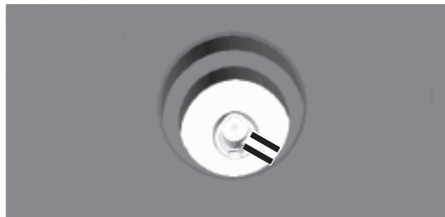
Afb. 81: Ontluchtingsslang bij ontluchter
