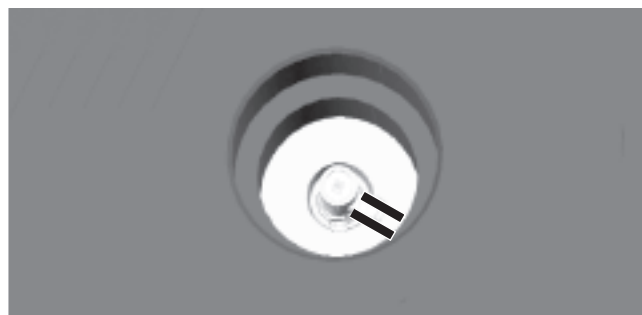
Afb. 81: Ontluchtingsslang bij ontluchter
