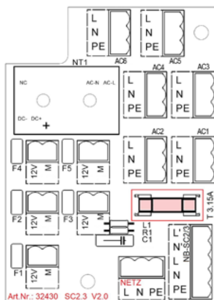
Afb. 100: Uitbreidingsprintplaat voor de netwerkaart van de SolvisControl 3
