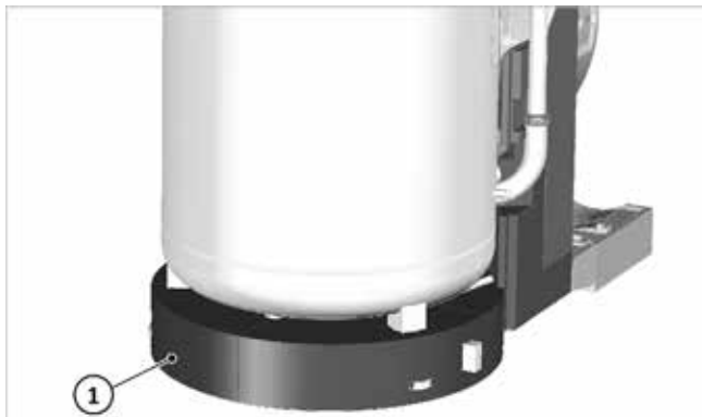
Afb. 12: Rond vloerdeel onder de boiler leggen
