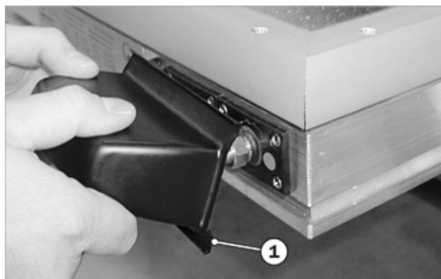
Fig. 55: Colocar la cubierta protectora
