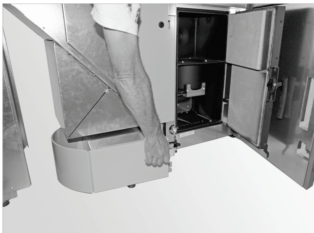
Abb. 100: Aschebehälter einschieben (LI-4-xx-VO)
