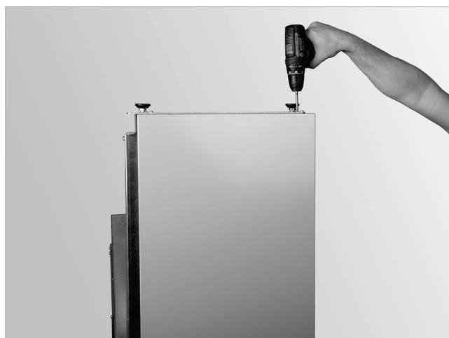
Abb. 51: Jeweils 1 Kreuzschraube entfernen
