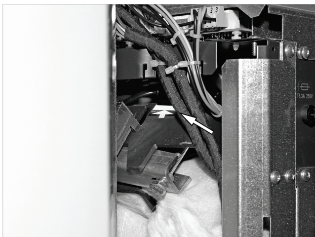
Abb. 58: Befestigung bis Anschlag festschrauben
