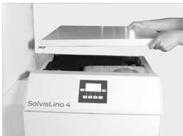
Abb. 129: Verkleidungsdeckel nach hinten abnehmen
