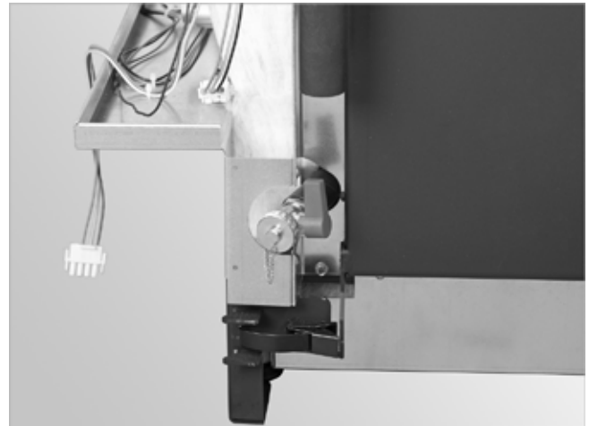
Abb. 27: Füll- und Entleerhahn eindrehen
