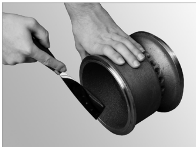
Abb. 147: Konus mit Spachtel reinigen
