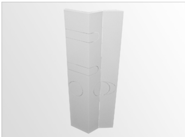
Abb. 71: Verkleidung leicht knicken
