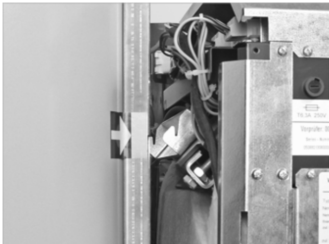
Abb. 29: Vorratsbehälter in beide Haken einhängen
