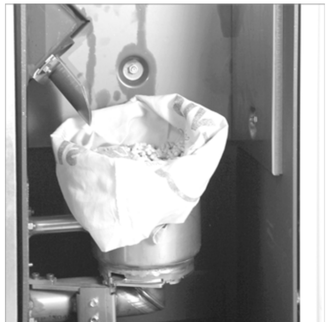
Abb. 122: Auffangbehälter / Sack unter Öffnung halten
