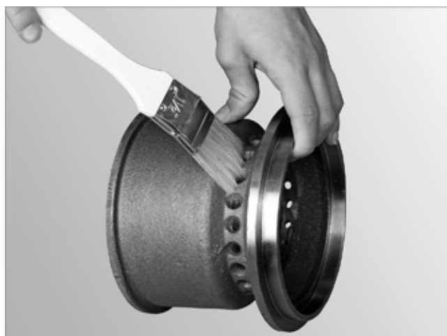
Abb. 146: Konus mit Pinsel reinigen
