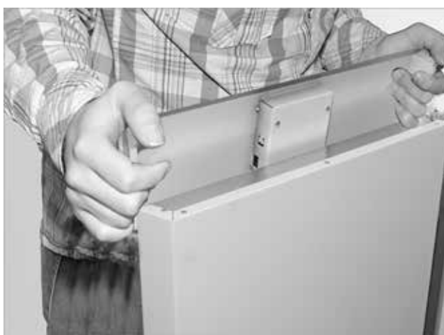
Abb. 113: Schalterblende in Tür einhängen
