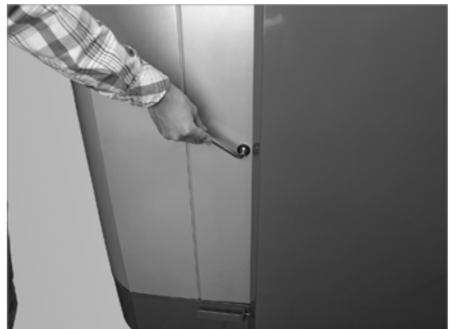
Abb. 125: Mit Sechskantschlüssel Verkleidung öffnen
