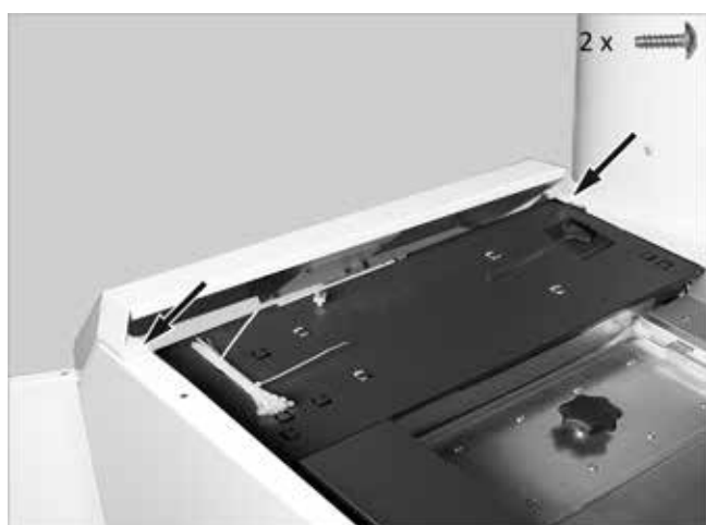
Abb. 110: Beide Schrauben an Schalterblende lösen
