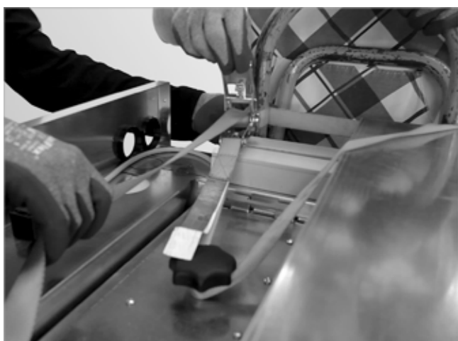
Abb. 10: Kessel an Sackkarre befestigen
