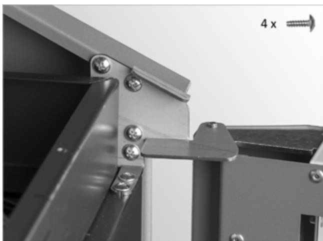
Abb. 89: Türscharnier und Seitenwand festschrauben
