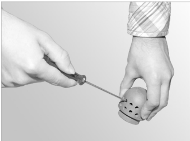
Abb. 150: Primärluftdorn vorsichtig reinigen
