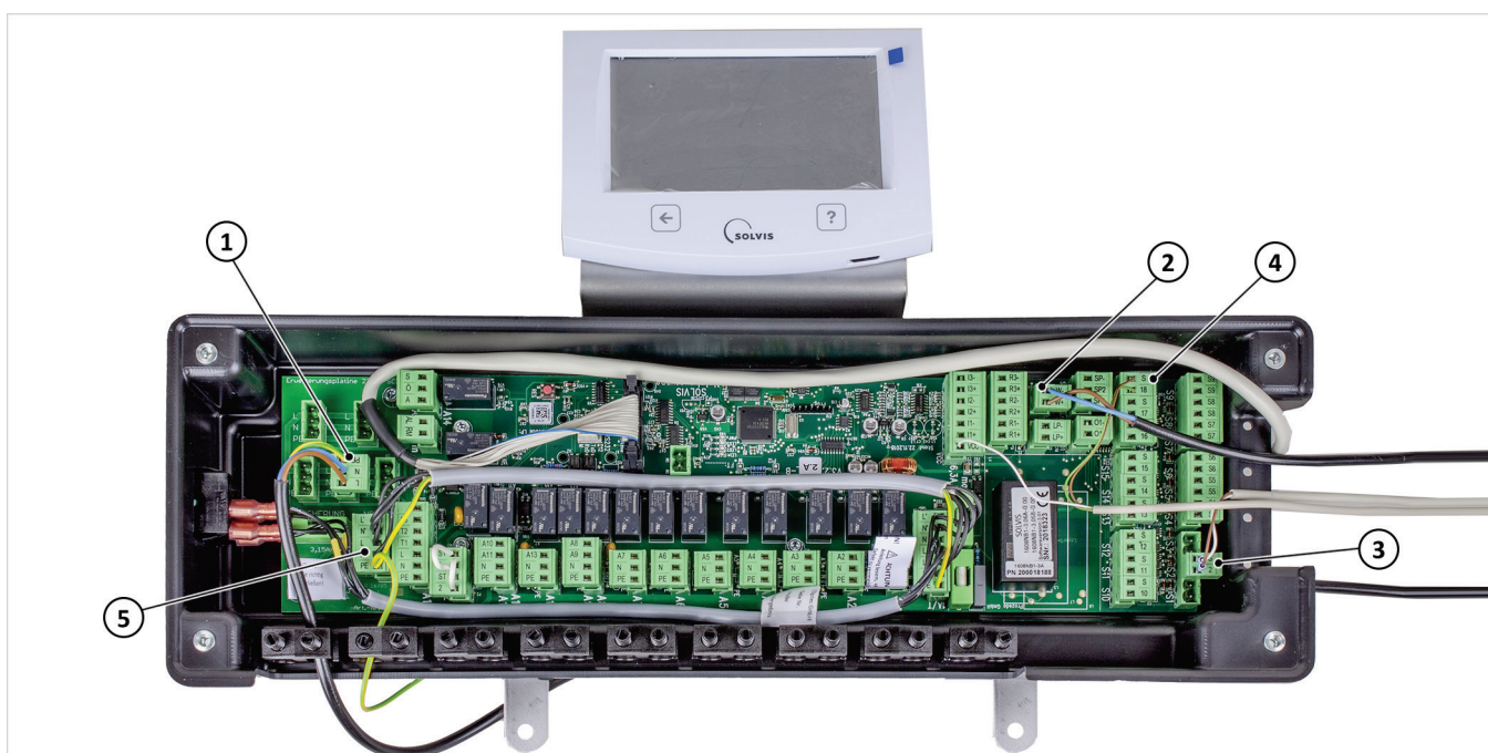
Fig. 26: Módulo de red SolvisControl 3
