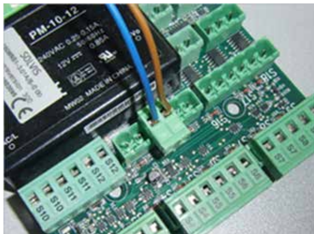
Abb. 2: Anschluss Gasdruckwächter an S14
