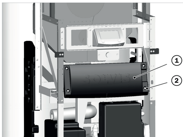
Abb. 19: Deckel der Netzplatine befestigen
