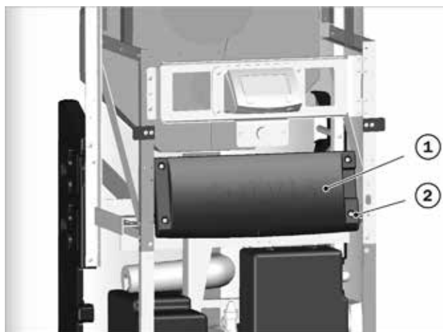
Abb. 19: Deckel der Netzplatine befestigen
