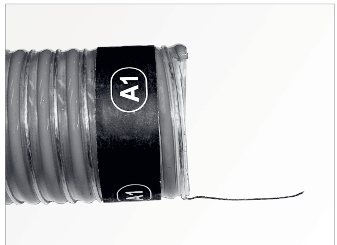
Abb. 19: Erdungsdraht freilegen, Schlauchende beschriften
