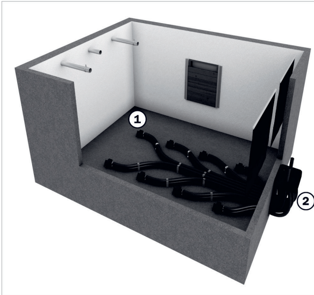
Abb. 8: Pelletlagerraum mit 8-Saugsonden-System
