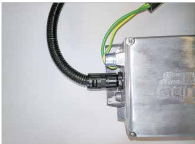
Abb. 7: Hochspannungskabel an Steuerungsbox montiert
