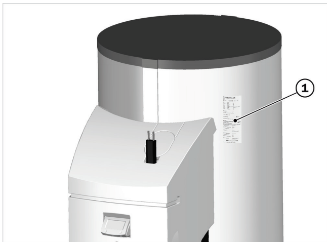
Fig.108: copia della targhetta (1) applicata sull'isolamento
