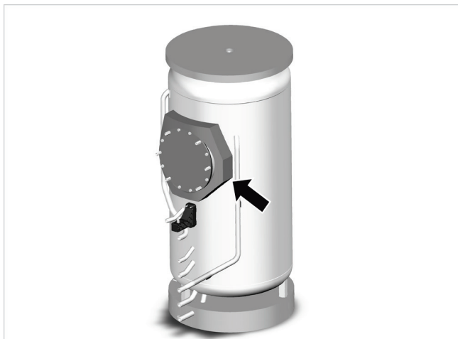
Fig.5: montaggio del collare della flangia
