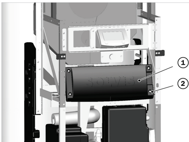
Fig. 95: fissaggio del coperchio del gruppo di rete
