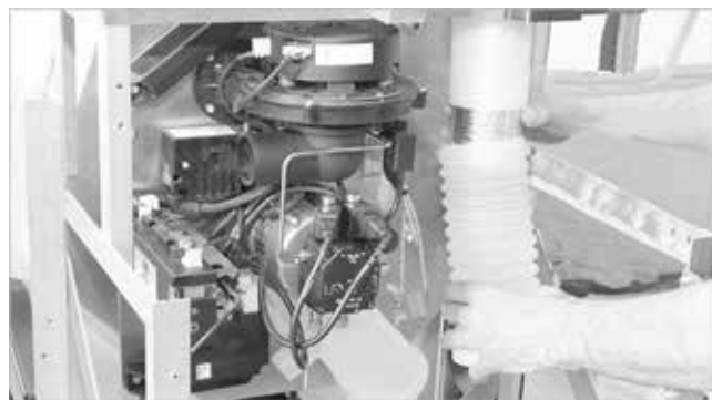
Fig.60: Montaggio raccordo per lo scarico dei fumi
