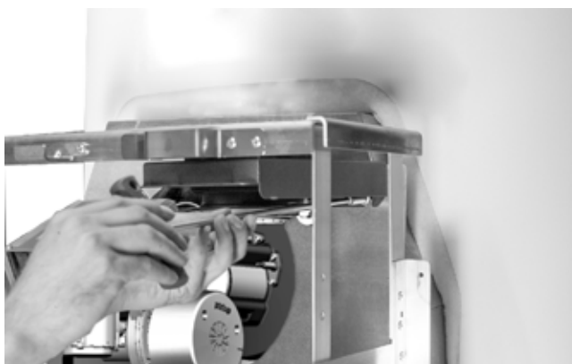
Fig. 34: Serraggio del supporto della tenuta a soffietto
