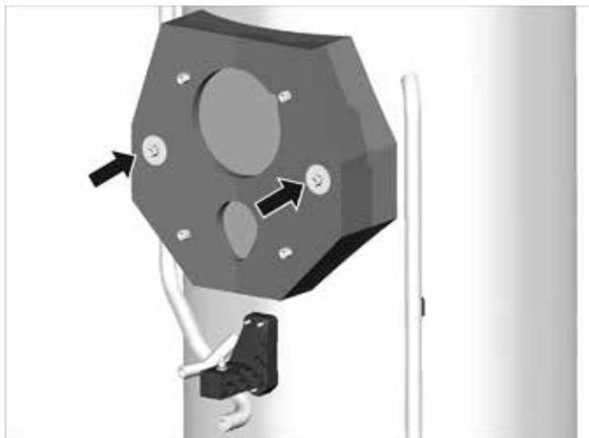
Fig.6: montaggio dell'isolamento posteriore della flangia
